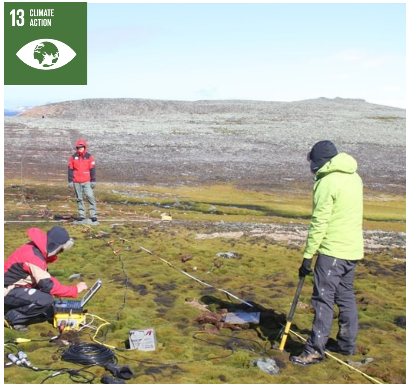
Geoelectric study of permafrost (Antarctica).
